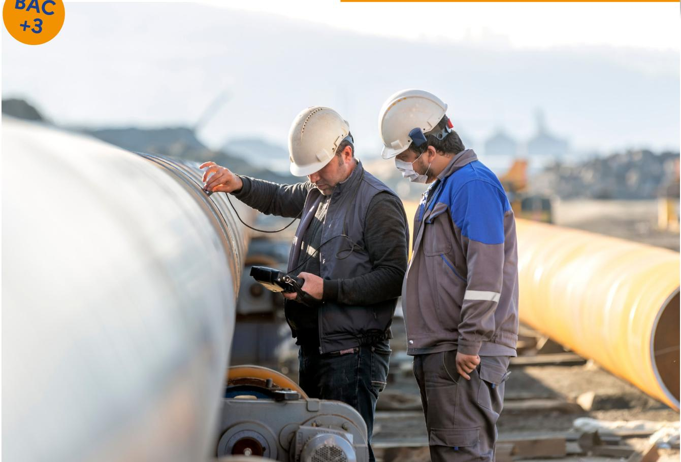
Le Contrôle Non Destructif (CND), ou encore les Essais Non Destructifs (END) sont un ensemble de méthodes permettant de caractériser l'état d'intégrité de structures ou de matériaux, sans les dégrader et à différents stades de leur cycle de vie.
